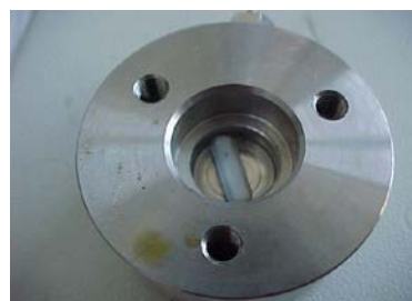
Dynamische Mischkammer mit Rührer
