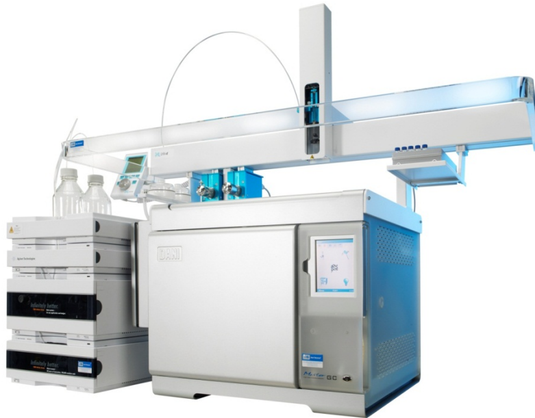
Abb. 17: HPLC-GC-System bestehend aus Autosampler, HPLC-UV und GC (Ref. Fa. Axel Semrau GmbH)
