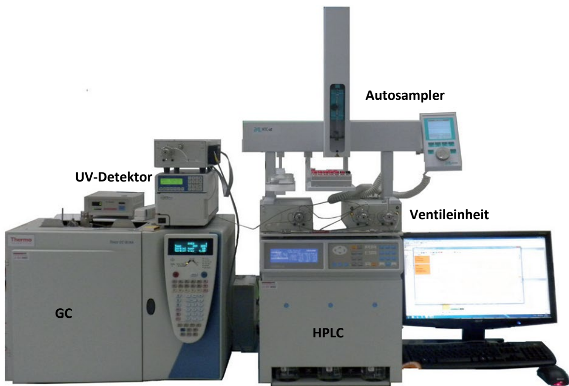
Abb. 1: Allgemeiner Aufbau eines LC-GC-Systems (LC-GC 9000 der Brechbühler AG)
